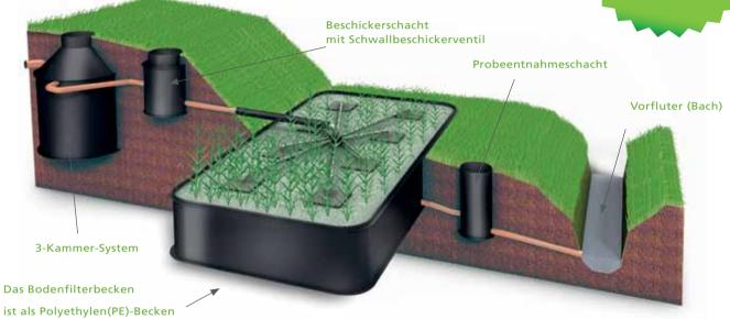
Unsere Pflanzenkläranlagen reinigen mittels 3-Kammer-System (als mechanische Vorreinigung) und über den vertikal durchströmten Bodenfilter als biologische Reinigungsstufe.
